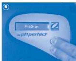
Pro spuštění nastavení musí být přístroj zapnutý. Stiskněte zároveň po dobu 5 vteřin tlačítka CAL/ester a SET/Esc, dokud se na display nezobrazí „Settings“ (nastavení – obr. B)
