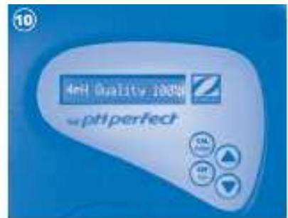
9a/ Stiskněte tlačítko cal/ enter pro spuštění kalibrace pH 4. PO vyzvání stiskněte znovu tlačítko cal/enter.
