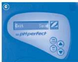
Pro opuštění menu stiskněte STE/esc tlačítko a vyberte YES (ano) nebo NO (ne) pomocí směrových šipek pro uložení nebo neuložení změn. Potvrďte výběr stisknutím tlačítka CAL/enter. (obr. C)
