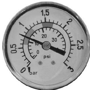
0,8 kg/cm 2 - 11,4 PSI: běžný tlak ve filtru nezaneseném nečistotami
