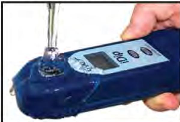
Zakryjte měřící celu víckem a stiskněte ZERO/ON pro nastavení "0" hladiny před samotným měřením. Na displeji se následně objeví hodnota "0 ppm", přístroj je připraven k měření.
